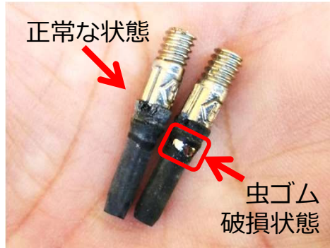
破損時交換が必要
